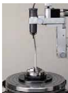
Měření dotekem pro malé otvory
