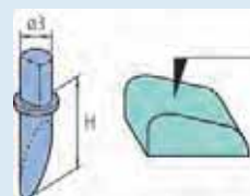
Jednostranně zkosený Úhel hrotu: 12° Rádus hrotu: 25 µm Materiál hrotu: Tvrdokov
