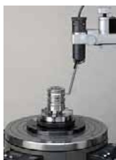
Měření dotekem rohovým
